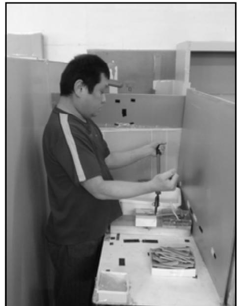
切るポイントを示すために角材を用意し、そこにクリップと台を2つ乗せました。クリップでケーブルを固定し、台と台の間に出来る谷間でカットする算段です。ご本人は道具を使うだけでなく、6工程もある作業も初めてです。作業用の道具を作成後は、本人の身長から考えて道具や材料の位置、机の高さ、どうしたら「終わり」が理解できるか、シミュレーションを繰り返した後、実際に評価を行いました。
